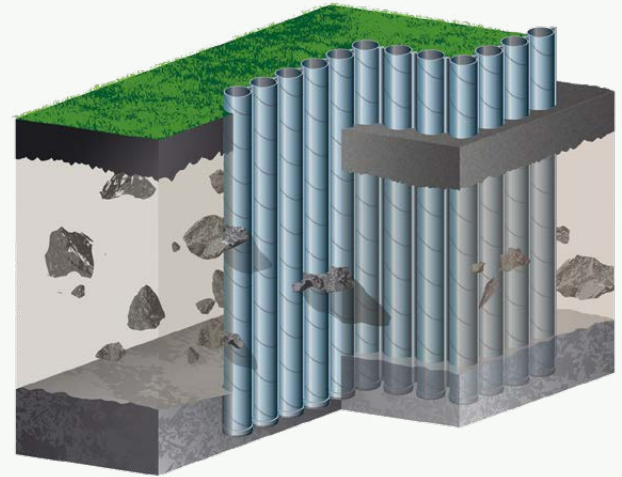
Kuva 4. RD-paaluseinä muodoltaan vaihtelevassa seinärakenteessa
