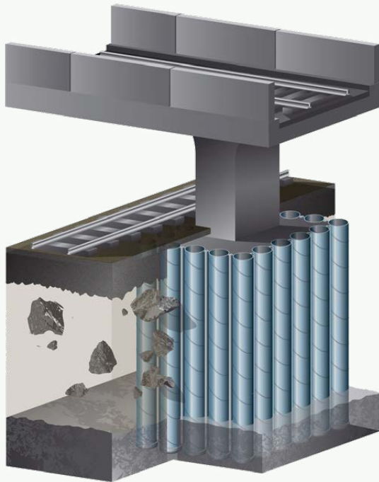
Kuva 7. RD-paaluseinä törmäyskuormitetun sillan välituessa
