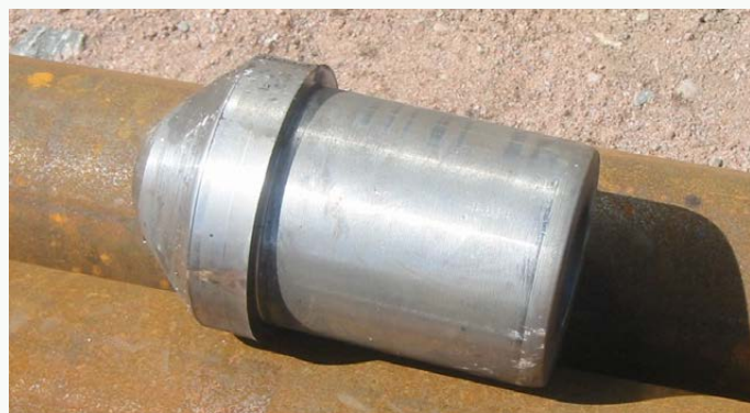
Kuva 12. Esimerkki hydraulivasaran terän ja paalun välisestä lyönninaikaisesta sovitinkappaleesta.
